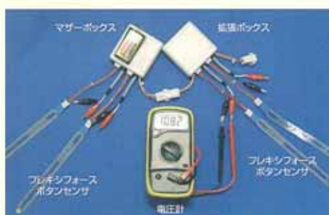
◀ボタンセンサ、マザーボックス、拡張ボックスの接続例
