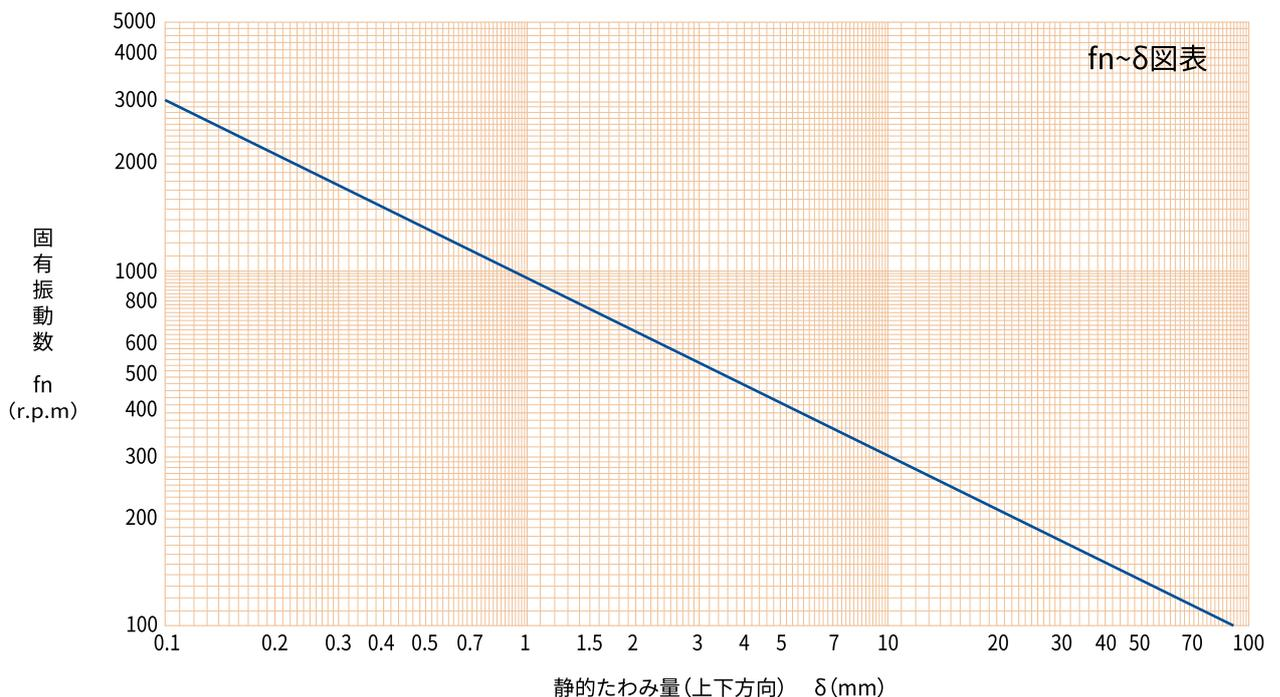
防振ゴムを設計する場合、防振効果の設定をし、振動数比の決定を行いません。振動数比と機械の振動数から必要な固有振動数を算出し、機械の重量との関係から防振ゴムに必要なバネ定数を決定します。
